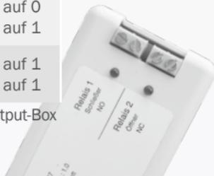
Das Gerät hat eine Schaltleistung von max. 60W (Strom max. 5A, Spannung max. 30VDC); Sie können somit das Gerät direkt in die Zuleitung der meisten Verbraucher einbinden.
