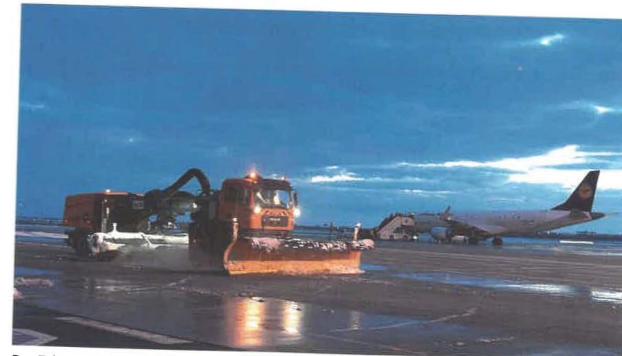
Das Telematiksystem liefert Live-Daten über den aktuellen Stand der Räum- und Streuvorgänge in Echtzeit an die Disposition.
